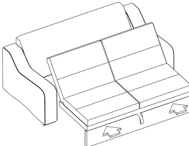
3. Устанавливаем выкатную часть в диван на роликах.
