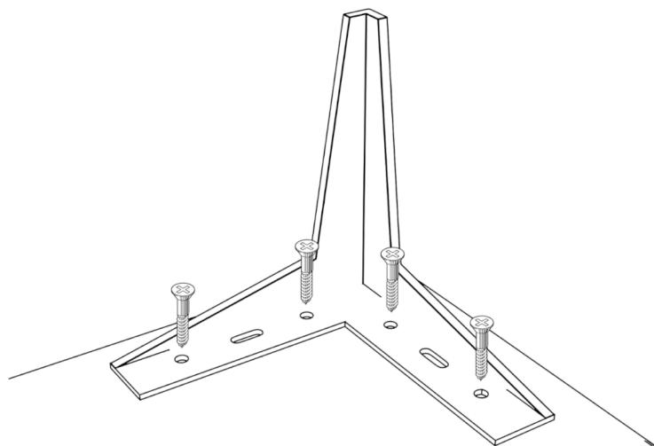
2. Ножки, крепятся на саморезы (1 ножка на 4 самореза). В комплекте поставки 6 ножек.
