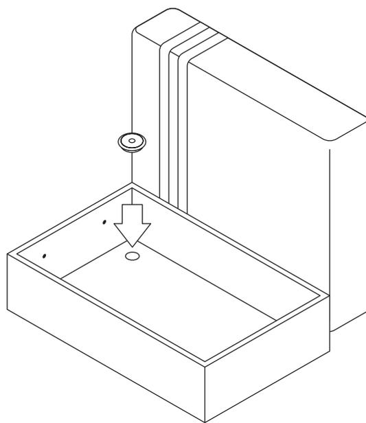
**2.** Поднимите спинку на модуле ящика и установите вентиляционную заглушку.
