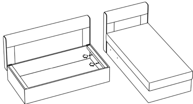
2. Прикрутить основную часть дивана к оттоманке 2 болтами М8 (90мм).
