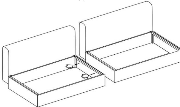
1. Устанавливаем две части дивана (ящики с задней спинкой) на пол и скрепляем их между собой болтами 2 шт.
