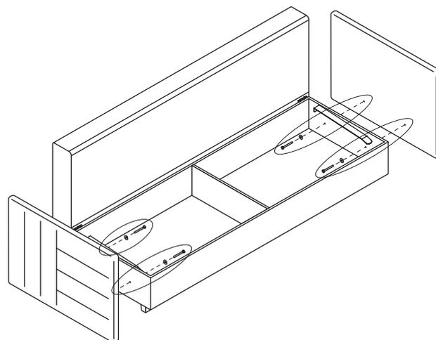
**2.** Прикрутить подлокотники к модулю бельевого ящика при помощи 4-х болтов М8х65 и 4-х шайб М8.
