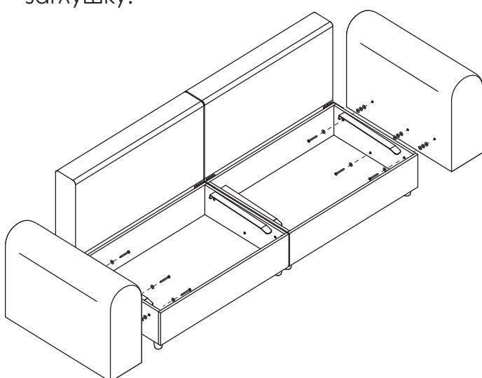
3. Прикрепить подлокотники к ящикам при помощи 3-х болтов M8x90, 3-х шайб M8 и 9-ти нейлоновых шайб. Нейлоновые шайбы расположить по 3 штуки на каждый болт между подлокотником и модулем ящика.
