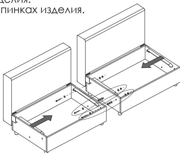
2. Скрутить модули бельевых ящиков между собой при помощи 3-х болтов M8x90 и 3-х шайб M8. Между модулями на двух болтах установить по 3 нейлоновых шайбы. С обратной стороны зафиксировать с помощью 3-х шайб M8 и 3-х гаек.
